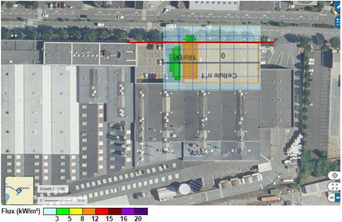
Seuls les flux de 3 kW/m<sup>2</sup> sortent au nord du site (la limite de propriété au droit de la zone modélisée est tracée en rouge).
